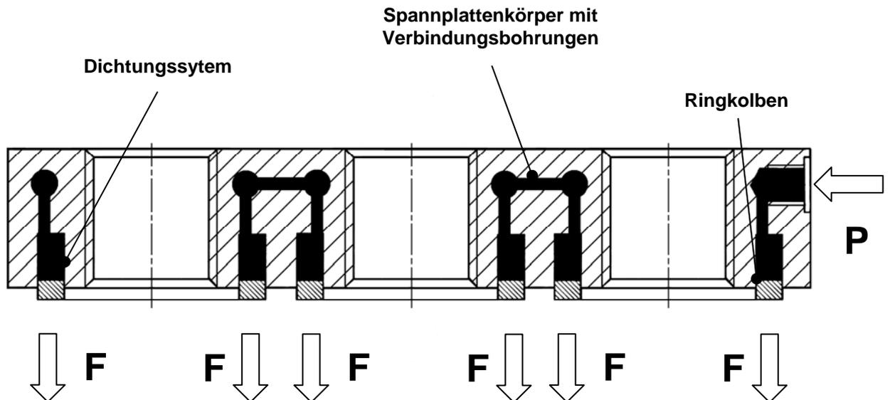
Hydraulische Spannplatten sind eine Zusammenfassung mehrerer einzelner hydraulischer Spannmutter.
