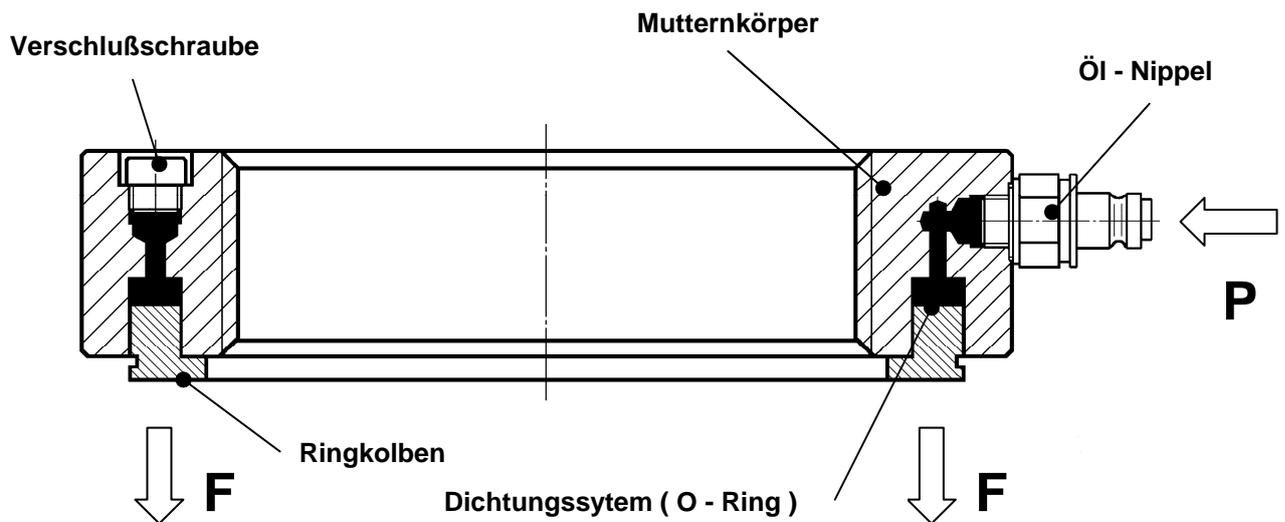
Die Hydraulikmutter dient zur temporären Druckbeaufschlagung.
